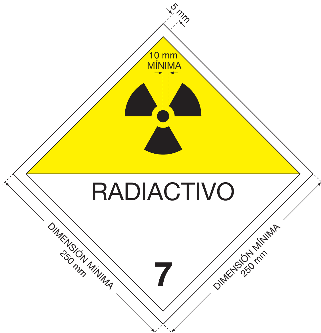
Fig. 6. Rotulado. Salvo en los casos permitidos en virtud del párr. 571, las dimensiones de este modelo son las mínimas; cuando se utilicen rótulos de distintas dimensiones deben guardarse las mismas proporciones que en el modelo. El número “7” tendrá una altura no inferior a 25 mm. El color de fondo de la mitad superior del rótulo será amarillo y el de la mitad inferior blanco, el trébol y los caracteres y líneas impresos serán negros. El empleo del término “RADIOACTIVO” en la mitad inferior es facultativo, con el fin de permitir también la utilización de este rótulo para indicar el número apropiado de las Naciones Unidas correspondiente a la remesa.
